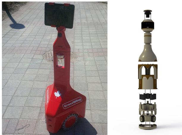
FIGURE 1 – Robot VirtualME et représentation explosée du Bishop de Crosswing
