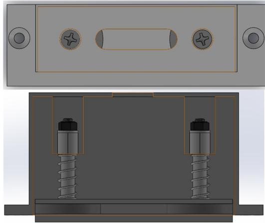
FIGURE 6 – Design de la boîte de contact dans le logiciel SolidWorks (vue de devant et du dessus)
