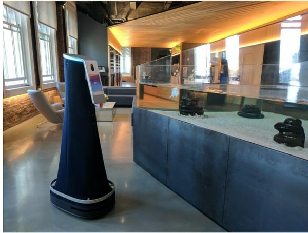
FIGURE 3 – Robot de sécurité Cobalt
